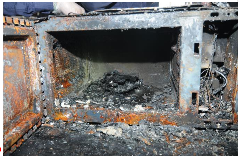
微波爐內部有受燒碳化嚴重之長方形紙盒。
