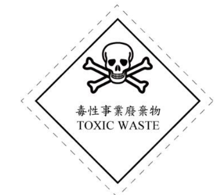
(重金屬) 廢液承盤用標示
